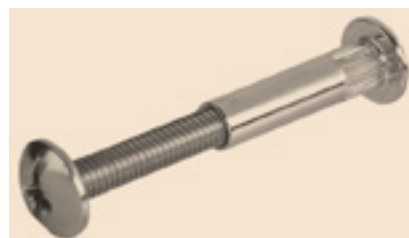
Hülenschraube: Außendurchmesser 8 mm, Schraube M6, Hülsenmutter M6
